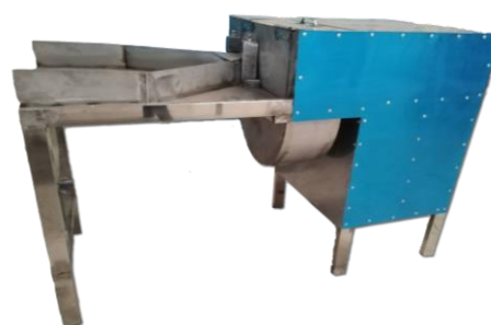
รูปที่ 4 เครื่องหั่นฟ้ายะลวยที่ผู้วิจัยสร้างขึ้น
